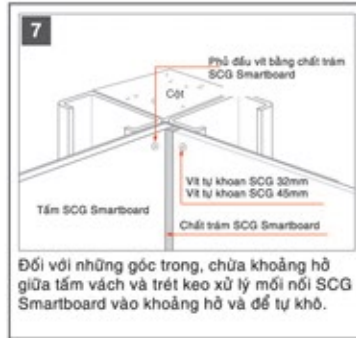
3. Cố định tấm SCG Smartboard dày 8-12mm bằng vít tự khoan 32mm, mỗi vít cách nhau 20cm và cách cạnh tấm Smartboard 1.2cm. Cố định tấm SCG Smartboard 16mm bằng vít tự khoan 45mm.
